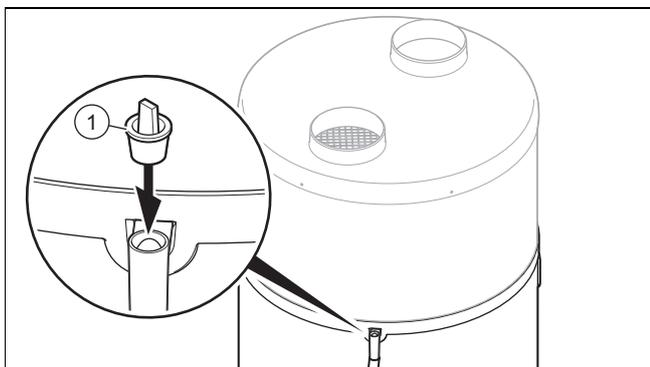
1. Vérifiez que le bouchon (1) sur le raccord d'évacuation des condensats est enlevé avant la mise en marche du produit.
