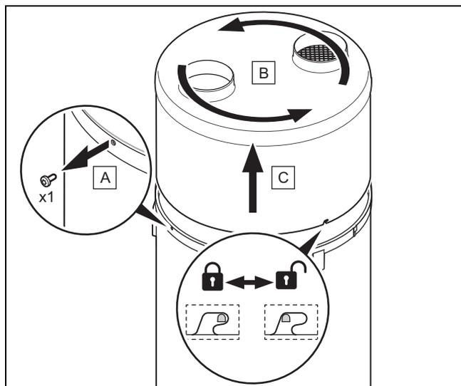
1. Dévissez de quelques millimètres la vis **(A)** située sur la virole du produit avec un tournevis Torx.
