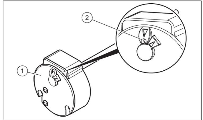
1. Avant de réinitialiser la sécurité de surchauffe (1), vérifiez si la coupure de fonctionnement n'est pas due au déclenchement d'un contacteur heures creuses ou à la programmation horaire.
