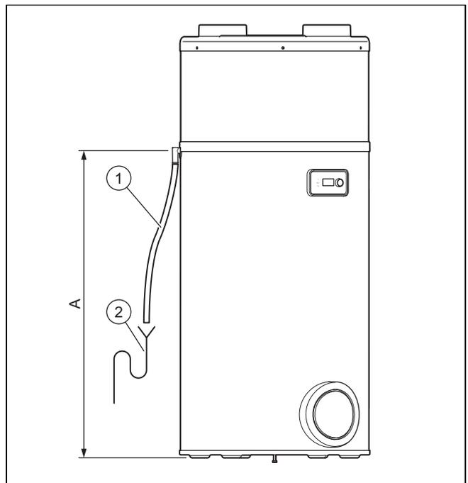
1. Raccordez la conduite d'écoulement des condensats (1) à un siphon d'évacuation (2) installé au préalable.
