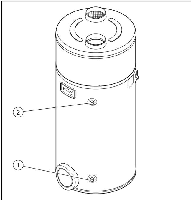
1. Procédez au raccordement de la conduite d'eau froide au niveau du repère (1).
