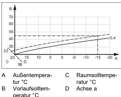
Wenn die Heizkurve 0,4 ausgewählt und für die Raumsolltemperatur 21 °C vorgegeben ist, dann verschiebt sich die Heizkurve wie in der Abbildung dargestellt. An der um 45° geneigten Achse a wird die Heizkurve entsprechend dem Wert der Raumsolltemperatur parallel verschoben. Bei einer Außentemperatur von -15 °C sorgt die Regelung für eine Vorlauftemperatur von 45 °C.
