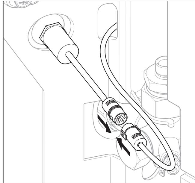
2. Tenez compte du fait que le limiteur de température monté sur le ballon est directement intégré à la phase du câble secteur. Mettez par conséquent le produit hors tension et raccordez le connecteur du produit au connecteur du limiteur de température prémonté d'usine. Sinon, la connexion du produit au réseau électrique est insuffisante.
