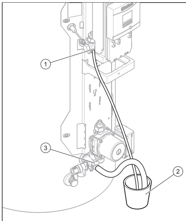
1. Raccordez un flexible suffisamment long pour aller jusqu'au sol au niveau de la soupape de purge (1).
