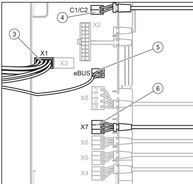
4. Faites passer le câble de raccordement de la pompe de protection anti-légionelles ou de la vanne d'inversion bypass dans l'ouverture du boîtier du régulateur, sans oublier le passe-câble.
